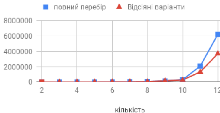
Рисунок 7 – Залежність варіантів поєднання елементів (синій - загальна кількість варіантів поєднання. Червоний - кількість варіантів відсіяних фільтром сумісності по портам)
