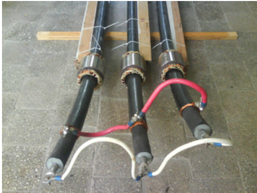
Рисунок 10 – Макет трифазної КЛ, кабелі якої охоплені ФО
