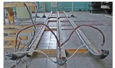
Рисунок 9 – Експериментальна установка з фізичним макетом КЛ
