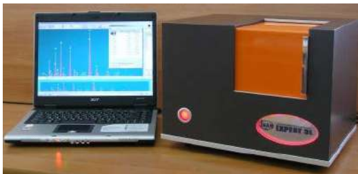
Енергодисперсійний рентгенофлуоресцентний аналізатор «EXPERT 3L»
