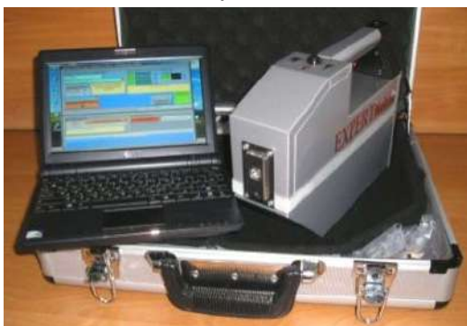
Портативний експрес-аналізатор складу сплавів «EXPERT Mobile»
