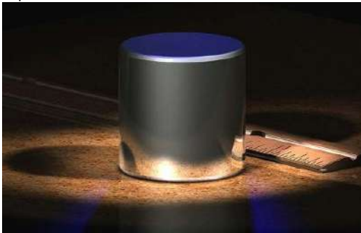
Еталон маси в 1 кг. Виготовлений із сплаву платини та іридію
