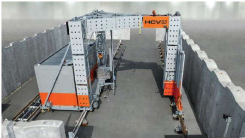
Рис. 4.6 - Рентгенівський сканер для огляду навантажених вантажних автомобілів і контейнерів «HCVG 6035»
