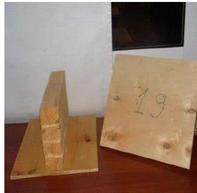
Рисунок 1 – Фрагмент дерев'яної балки для випробування з розміщенням термопар.
