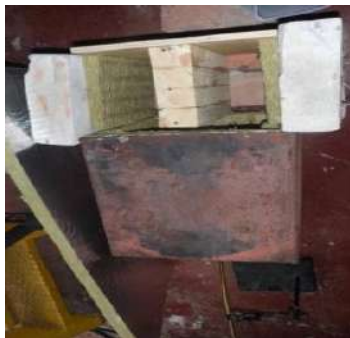
Рисунок 2 – Установка для проведення вогневих випробувань.
