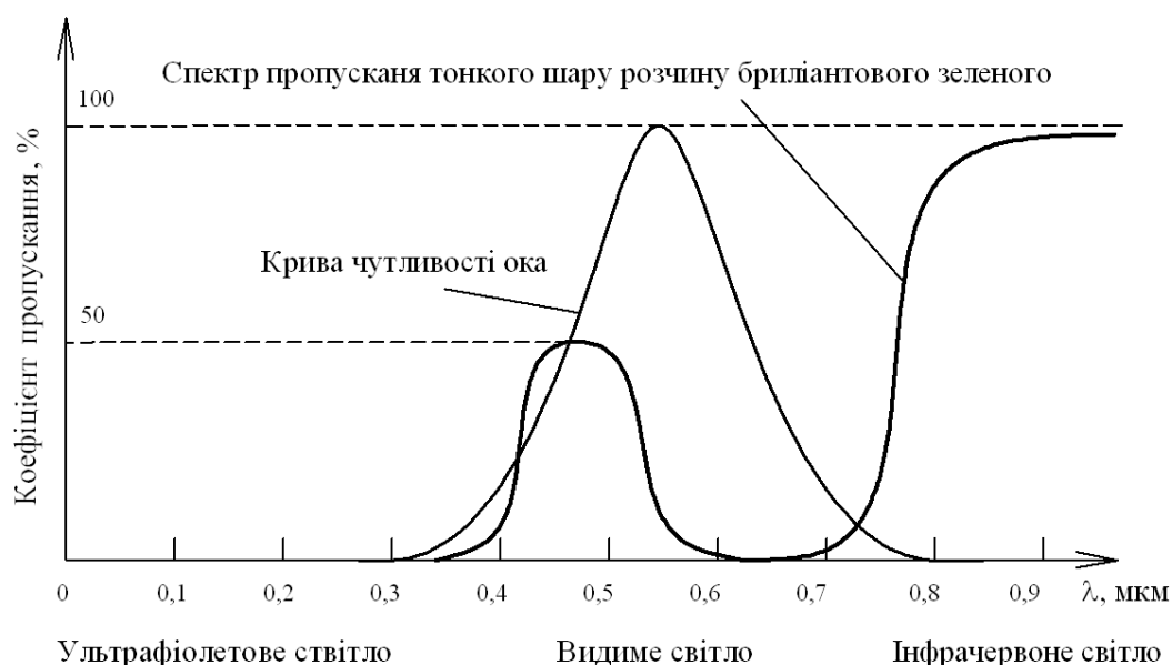
Рис. 3. Спектр пропускання тонкого шару розчину діамантового зеленого
