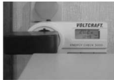
Моніторинг потужності шкільних електроприладів за допомогою електронного ватметра
