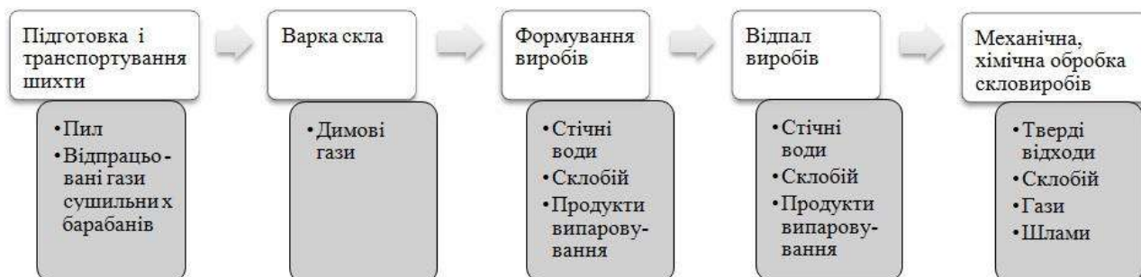
Рис. 1. Викид шкідливих речовин на стадіях технологічного процесу виготовлення сортового посуду
