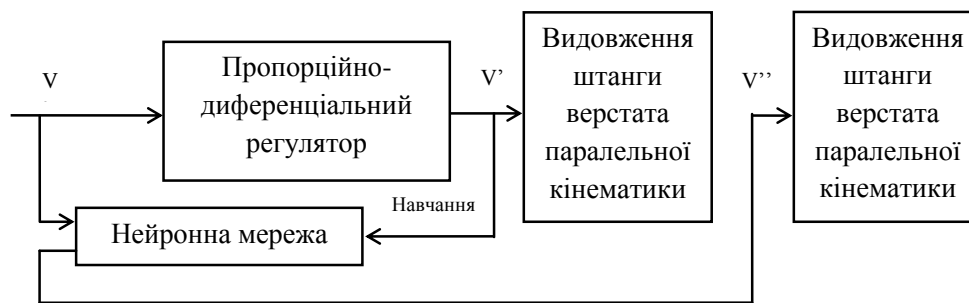
Рис. 8. Схема наслідкового нейрокерування на базі пропорційно-диференціального регулятора
