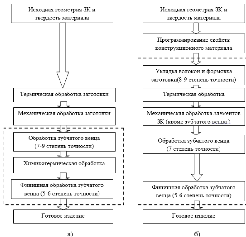
Рис. 1. Технологический процесс изготовления зубчатых колес из металлов (а) и ВПКМ (б)
