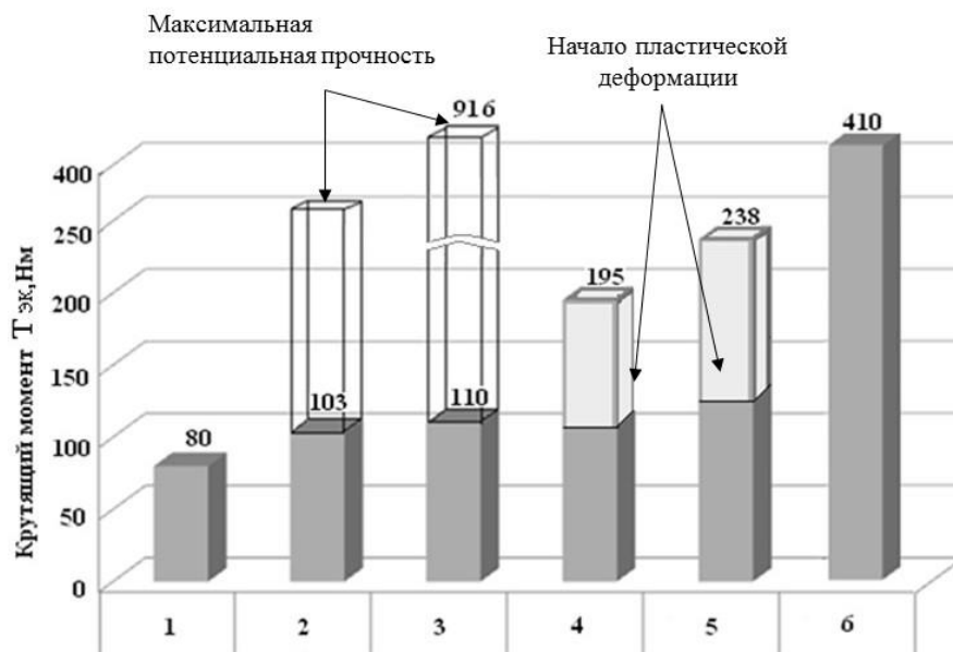
Рис. 4. Разрушающий крутящий момент для зубчатых колес из различных материалов: 1 – флубон; 2 – обработанный углепластик; 3 – углепластик без обработки; 4 – ПОМ; 5 – полиамид; 6 – сталь 45 (180 НВ)
