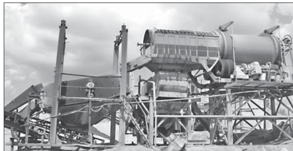
Рис. 3. Промивно-сортувальний комплекс з перероблення кварцитів Васильківського родовища зі скруббер-бутарою СБР-100
