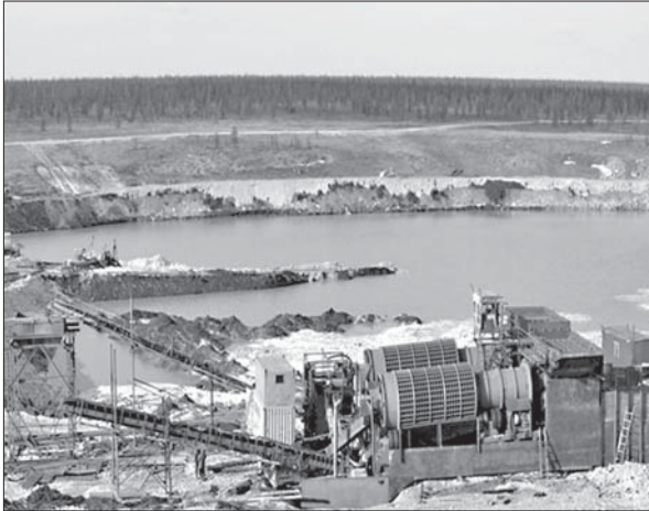
Рис. 5. Промивний комплекс діамантодобувного підприємства «Нижне-Ленское» (Якутія) з двома скруб-бутарями і вібраційним грохотом ГІСТ-72
