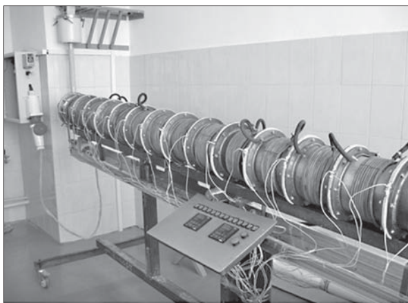
Роторна піч для виробництва нанодисперсних порошків тугоплавких сполук і оксидів, яка, працюючи безперервно, забезпечує вихід 25–30 т нанопорошку на рік (розробка Інституту проблем матеріалознавства ім. І.М. Францевича НАН України)
