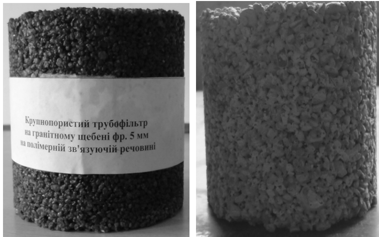
Рис. 4. Трубофільтри на основі модифікованого полімеру (а) та лужного цементу (б) із заповнювачем – гранітним відсівом фр. до 5 мм
