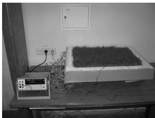
Рис. 1. Фізична модель екстенсивного зеленої покрівлі (за незначної швидкості повітря)
