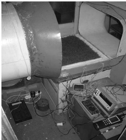
Рис.2. Фізична модель екстенсивної зеленої покрівлі (аеродинамічна труба)
