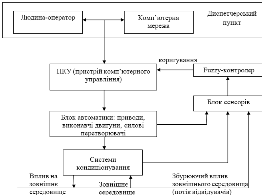
Рис. 1. Інтелектуальна мехатронна система управління мікрокліматом музейного приміщення
