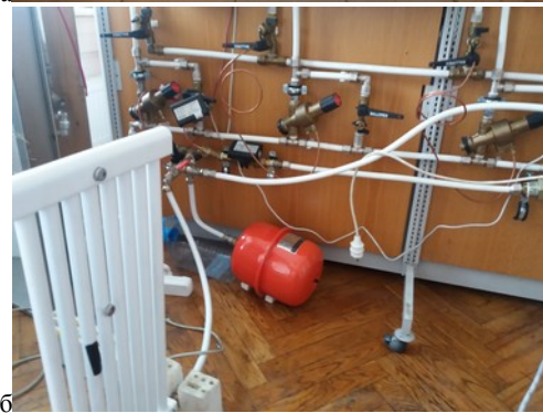
Рис. 1. Випробувальні стенди вакуумного радіатора: а) пластинчастого типу; б) трубчастого типу.
