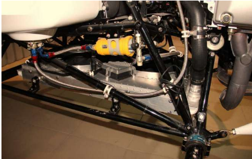
Рис. 1. Зібраний та встановлений на гелікоптер дослідний зразок нової СО з вентиляторами TEMIC
