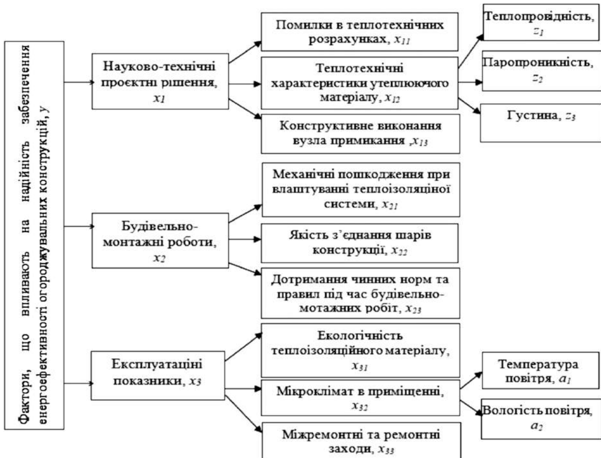
Рис.1 Класифікація факторів, що впливають на надійність забезпечення енергоефективності огорожувальних конструкцій у вузлах примикання
