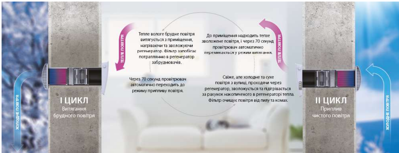
Рис. 1 Принцип роботи провітрювача Vents Twin Fresh [4]
